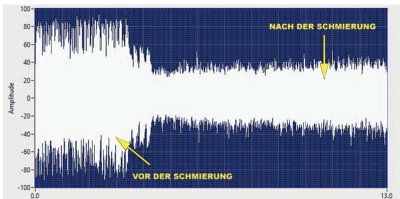
Diese Ansicht zeigt ein Lager, welches 13 Sekunden lang geschmiert wird. Wiederum zeigt sich ein deutliches Vorher- und Nachher-Bild.
