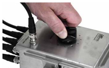
Paso 4 - Haga sus mediciones en los varios puntos de teste con el interruptor en la Switch Box
