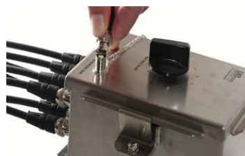
Paso 2 - Conecte los sensores a la Switch Box
