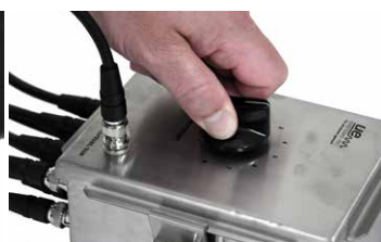
Krok 4 - Użyj pokrętła aby zmienić numer punktu i zapisać pomiar
