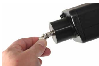
Krok 3 - Podłącz Ultraprobe do skrzynki
